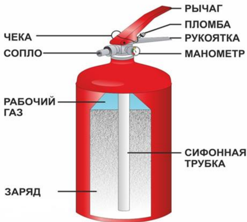
Рис. 1. Схема огнетушителя
